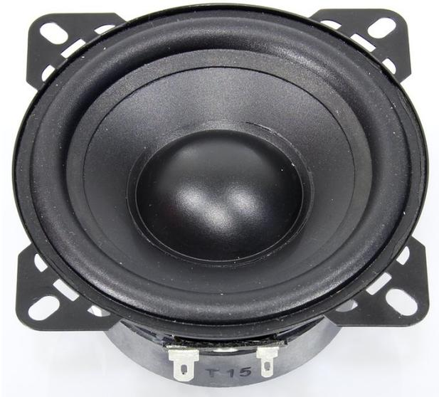
**10 cm (4") Tieftöner** mit niedriger Resonanzfrequenz bei kompakter Größe. Großer Hub möglich durch elastische Gummisicke und tiefen Magnet bei minimalen Störgeräuschen dank Polkernbohrung und Hinterlüftung des Luftspaltes. Einfacher Korb für flexible Montagemöglichkeiten.
